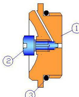
В латунном корпусе воздухоотводчика (1) имеется калиброванное воздуховыпускное отверстие диаметром 2 мм, которое в обычном состоянии перекрыто латунным винтом (2). При вывинчивании винта (2) скопившиеся в радиаторе газы через проточки винта и корпуса через газоотводный канал корпуса выходят наружу. Монтажное уплотнение обеспечивается с помощью кольца из EPDM (3)
